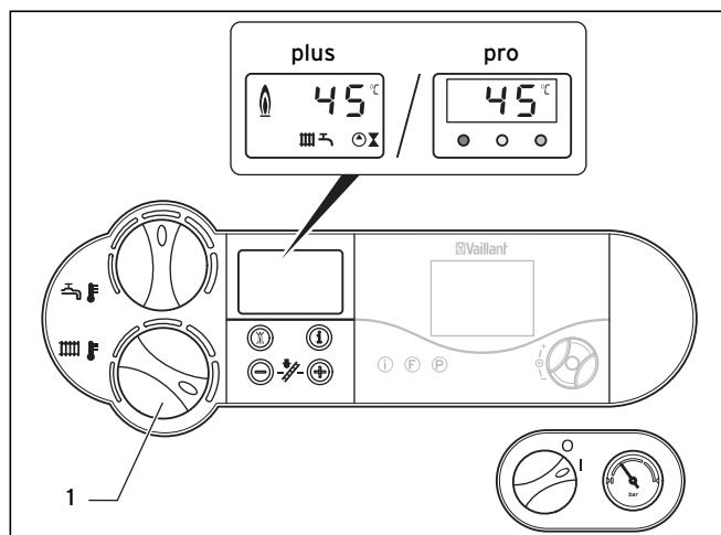
Abb. 4.14 Vorlauftemperatur-Einstellung bei Einsatz eines Regelgerätes
