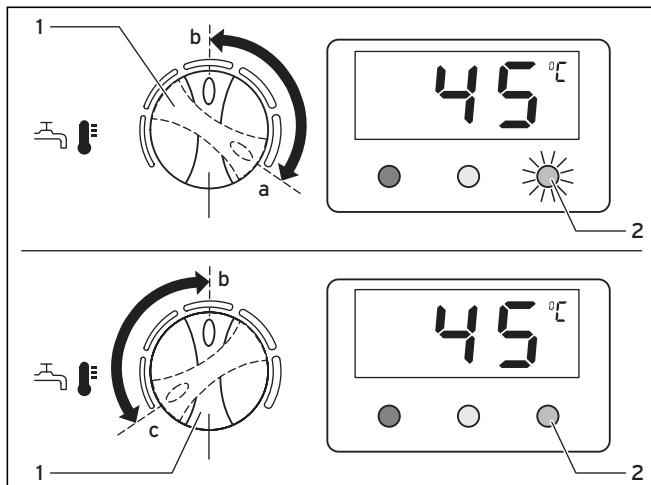
Fig. 4.9 Activation/désactivation de la fonction de maintien de la température de la chaudière ecoTEC pro
