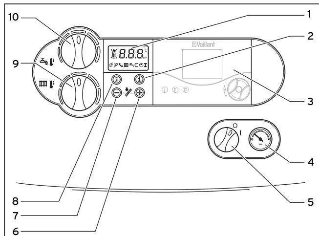
Fig. 4.1 Eléments de commande ecoTEC plus
