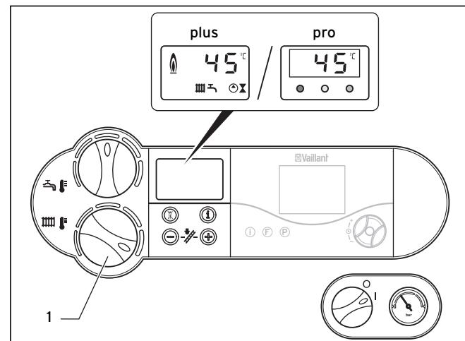
Fig. 4.14 Réglage de la température de départ avec appareil de régulation
