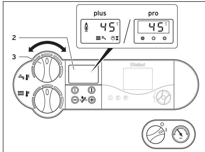
Abb. 4.7 Einstellung der Warmwassertemperatur
