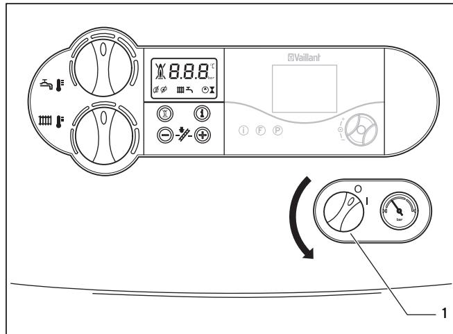
Fig. 4.19 Arrêt de la chaudière
