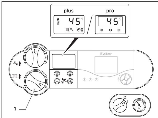
Afb. 4.14 Instelling voorlooptemperatuur bij het gebruik van een regelapparaat
