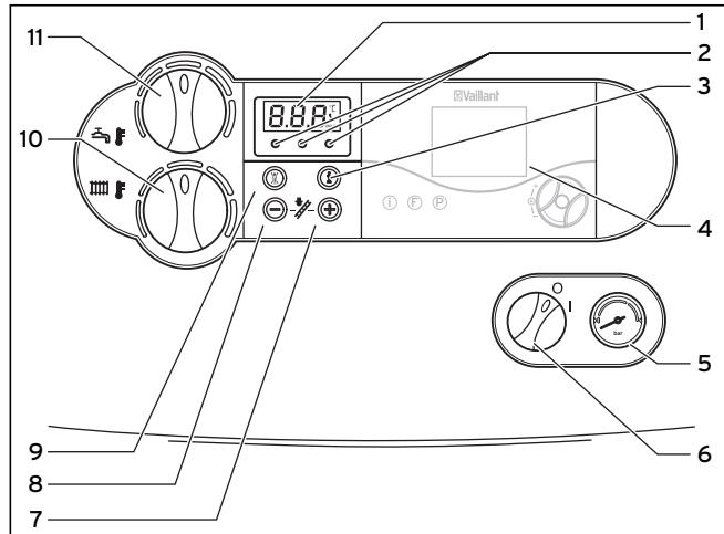
Abb. 4.3 Bedienelemente ecoTEC pro
