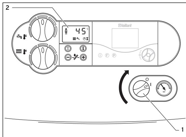
Fig. 4.6 Mise en service de l'appareil (exemple : ecoTEC plus)
