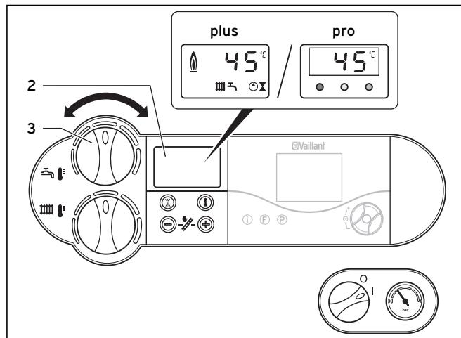
Fig. 4.11 Réglage de la température de l'eau chaude
