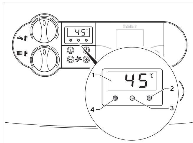
Abb. 4.4 Anzeigeleuchten ecoTEC pro
