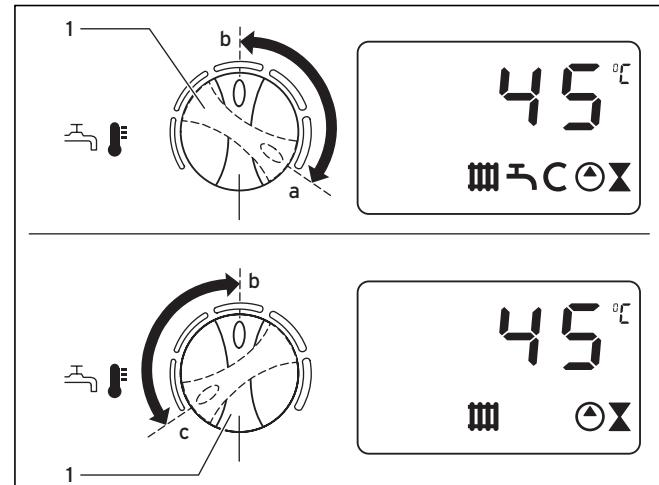
Fig. 4.8 Activation/désactivation de la fonction de maintien de la température de la chaudière ecoTEC plus
