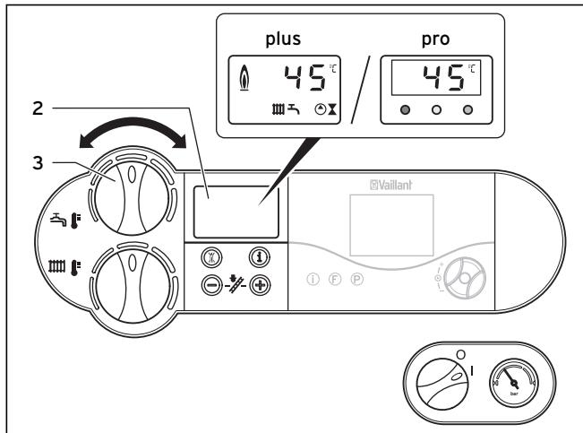
Fig. 4.7 Réglage de la température de l'eau chaude
