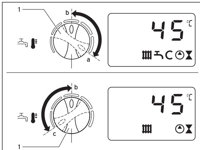
Abb. 4.8 Warmhaltefunktion ein- und ausschalten bei ecoTEC plus
