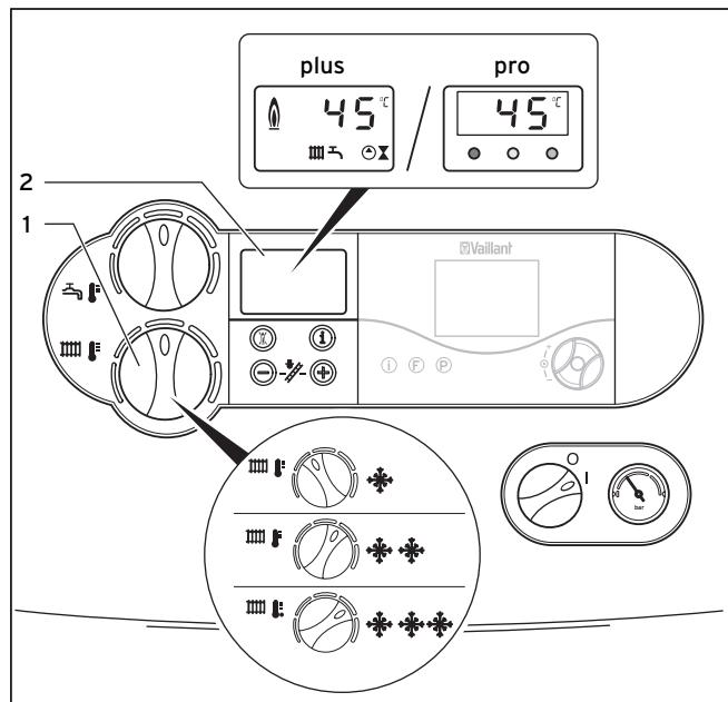
Abb. 4.13 Vorlauftemperatur-Einstellung ohne Regelgerät
