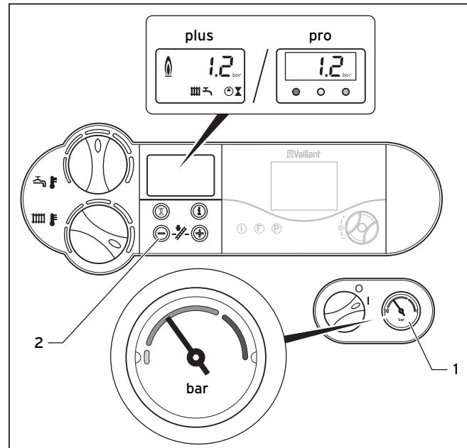
Abb. 4.5 Fülldruck der Heizungsanlage kontrollieren
