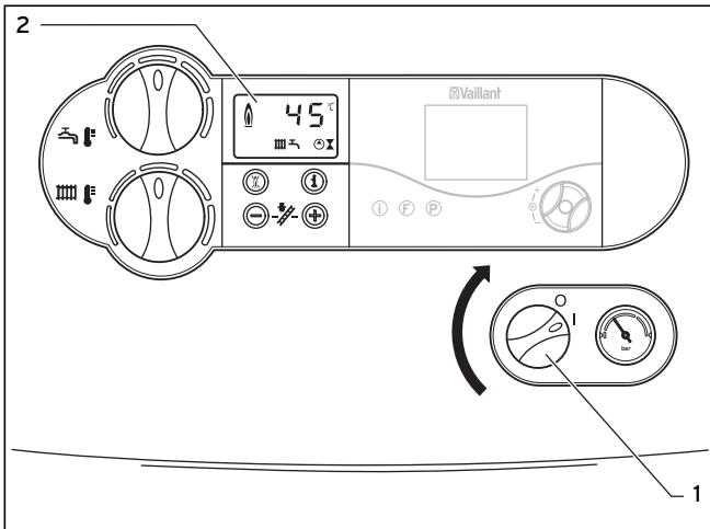
Abb. 4.6 Gerät einschalten (Beispiel: ecoTEC plus)
